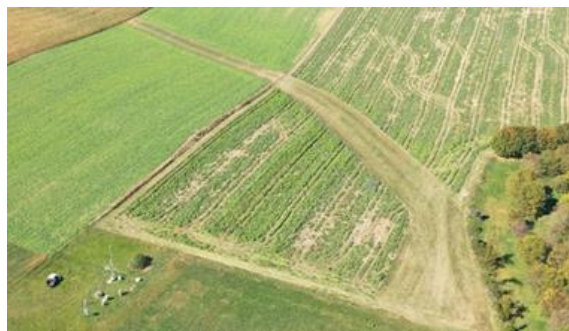
Porośnięta trawą droga splywu wody zastosowana w miejscu podatnym na erozję © BAW-IKT
