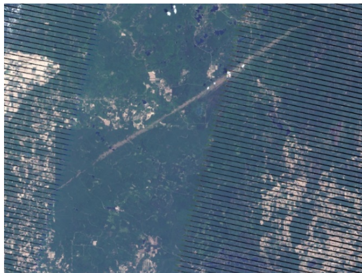
Rys. 2.7. Przykład zdjęcia wykonanego skanerem ETM+ z widocznymi paskami oznaczającymi brak danych Źródło: landsat.usgs.gov
